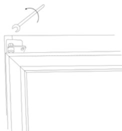
8. Draai de bovenste scharnierpen vast.
