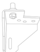
7. Placer la porte en place dans la charnière en haut.
